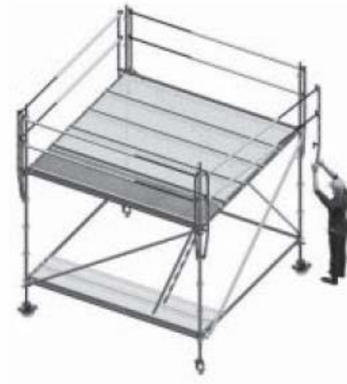
Figura 5 Montaje de barandillas y rodapiés desde el nivel superior
