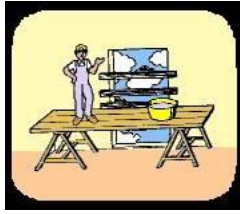
Fig. 16: Andamio situado junto abertura en pared protegida
